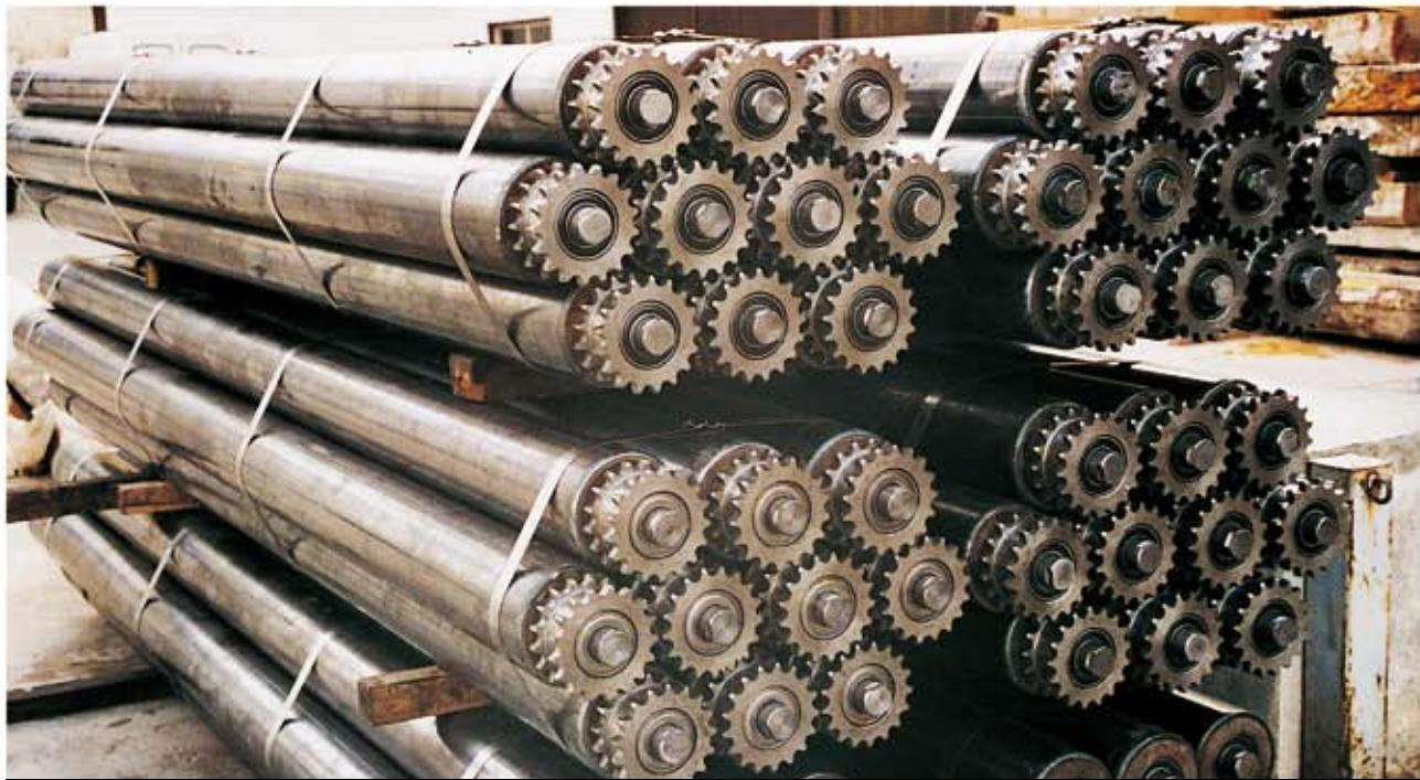
▲ RODILLOS PARA TRANSPORTE DE BOBINAS DE 25 TM DE ACERERÍAS (TREN DE LAMINACIÓN DE ACERALIA)
